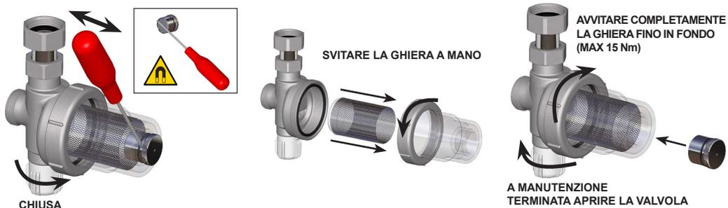
1- Chiudere la valvola. Aiutandosi con un cacciavite, rimuovere l'inserto magnetico dal vaso di raccolta.
