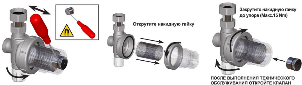
1 - Закройте клапан. Извлеките магнитную вставку с помощью отвертки
